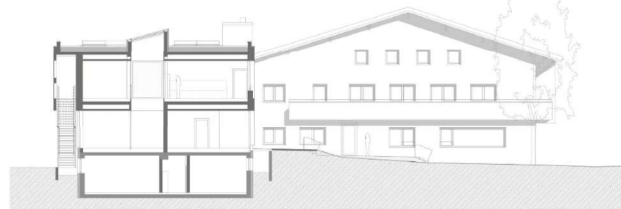
Sezione orizzontale della casa dei bambini e vista ovest dell'ex municipio
